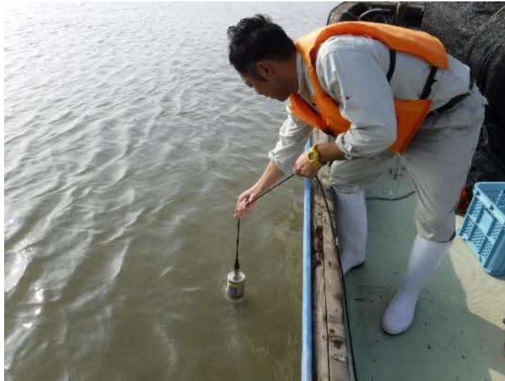
図5.2.4 直読式総合水質計による測定状況（六角川）
